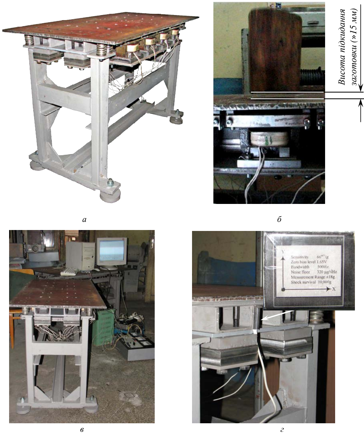
Рис. 23. Експериментальний зразок вібростола (а); фрагмент відеоролика, де зображено роботу вібростола (б); компонування обладнання під час експерименту (в) та датч, що приєднаний до маси m_1 (г) для знімання часових залежностей руху коливальної маси
