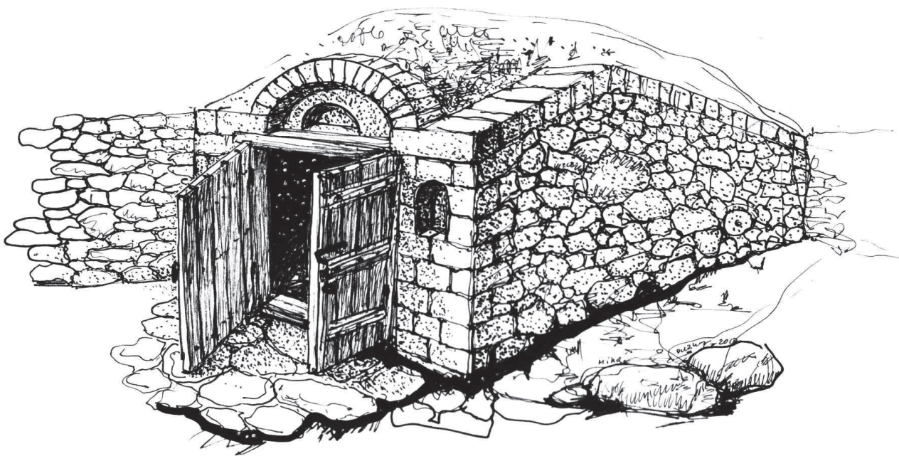
Рисунок 2. Погріб із тамбуром (Vesi cu gîrlîci); (кінець XIX ст., с. Бутучень Орхейського району). Габаритні розміри: погреб – 5100×10000, h = 2450; тамбура 2000×3800, h = 2450; матеріали: вапняк, дерево, метал. У науковий обіг увів автор.
