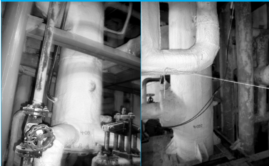
Рис. 3. Швидкісний підігрівник соку перед 2-ою сатурацією PSS-700
