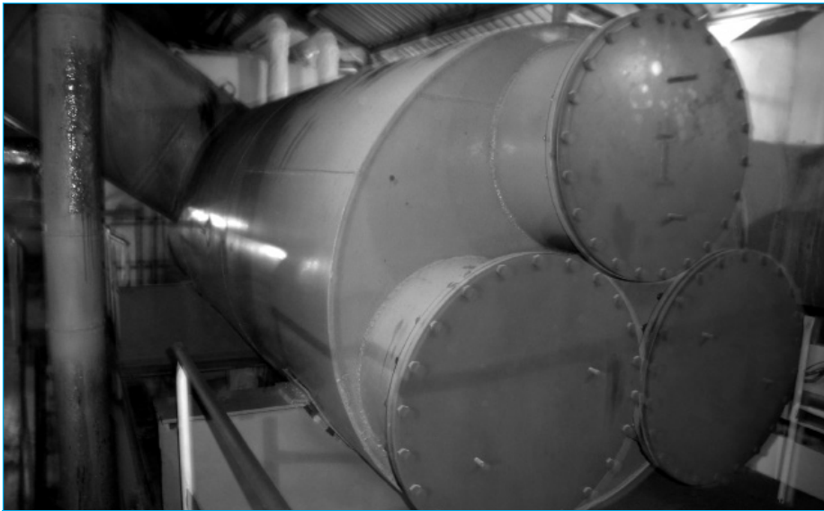
Рис. 2. Швидкісний підігрівник дифузійного соку ПДС-1800-У
