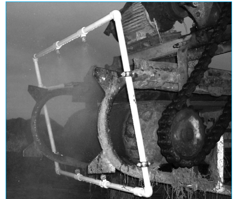
Рис. 4. Рамка з форсунками для розпилення робочого розчину
