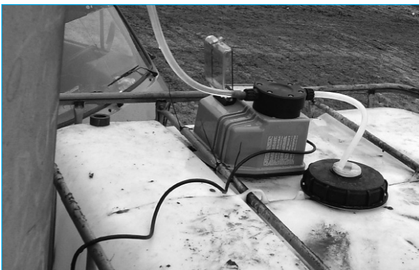
Рис. 2. Насос дозатор на ємкості з концентратом
