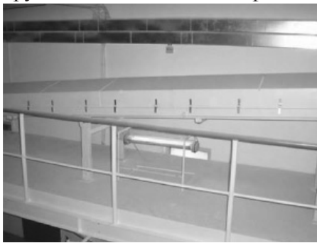
Рис. 2. Приклад застосування ультрафіолетових ламп під транспортером цукру
