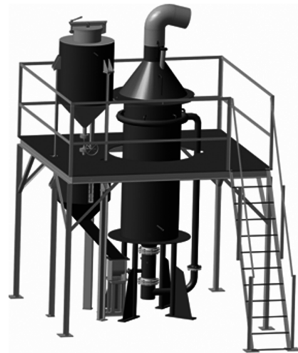
Рис.3. Установа для виробництва порожньотілих мікрокульок з перліту.
