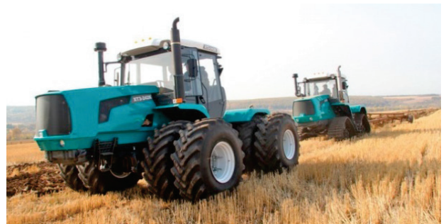
Рис. 2. Зняття тягових характеристик трактора ХТЗ-242К
