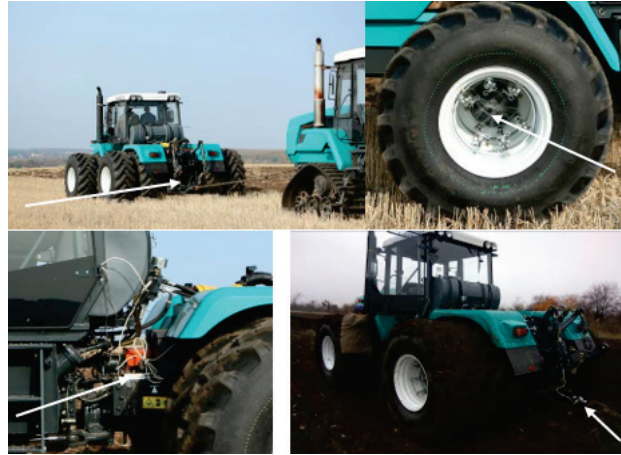
Рис. 4. Розташування датчиків на тракторі ХТЗ-242К
