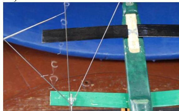
Рис. 7. Вільний вихор переднього крила при куті ковзання \beta = -5^\circ
