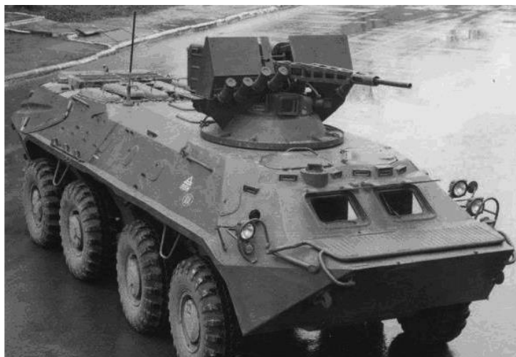
Рисунок 8 – Бронетранспортер БТР-70 с двигателем УТД-20
