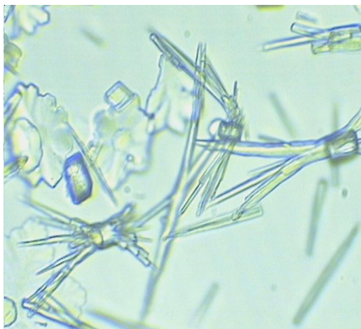
Рис. 3. Микрофотография кристаллов \text{CaCO}_3 ( \times 40 ), образованных при последовательной электрохимической и магнитной обработке кальциево-гидрокарбонатной воды.
