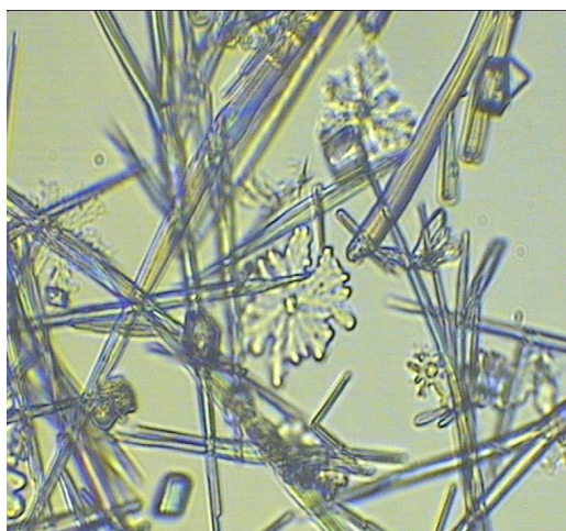
Рис. 2. Микрофотография кристаллов \text{CaCO}_3 ( \times 40 ), образованных при последовательной магнитной и электрохимической обработке кальциево-гидрокарбонатной воды.
