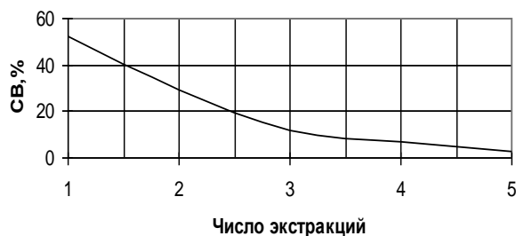
Рис. 2. Зависимость выхода сухих веществ ячменя в раствор от числа экстракций ( t = 45 \text{ }^\circ\text{C}, \tau = 30 \text{ мин}, \text{pH} = 10, \text{ГМ} 10 , при перемешивании)
