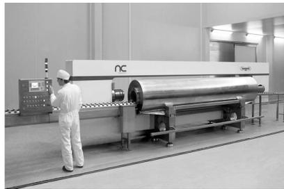
Рис. 1. Оборудование для обработки пищевых продуктов высоким давлением
