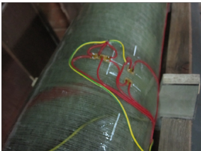
Рис. 4. Общий вид расположения тензодатчиков на лицевой поверхности банджа
