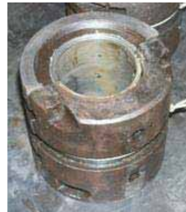
Рис. 4. Изношенные поверхности упорных (а) и опорных (б) подшипников скольжения
