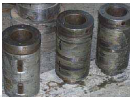
Рис. 1. Разрушение баббитового слоя опорных пальцев зубчатых колес
