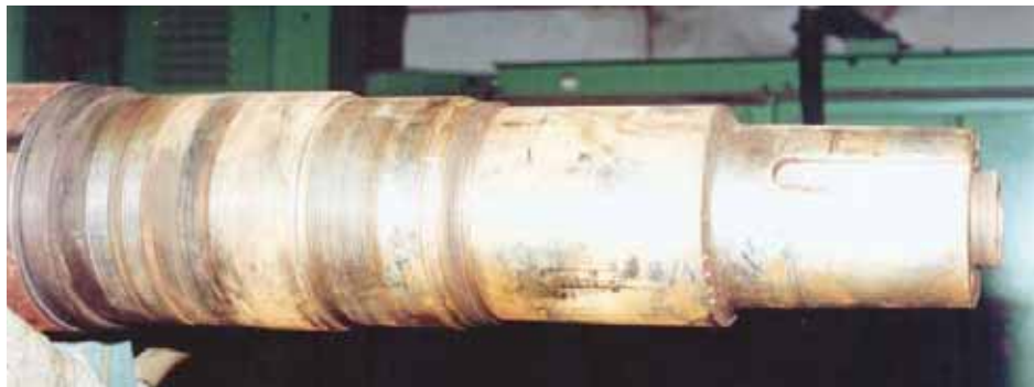
Рис. 3. Вала ротора насоса ЦНС-180 с изношенными поверхностями
