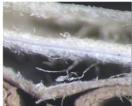
Рис.2 а) мікрофотографії клею NATIONAL 48235, б) поперечний розріз кашированого картону
