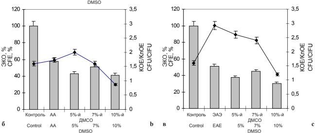
Эффективность колониеобразования ЭКО и КОЕ/КлОЕ КМ контрольных животных (а), с АА (б), с ЭАЭ (с) до и после криоконсервирования с различными концентрациями ДМСО: ■−ЭКО; ◆−КОЕ/КЛОЕ.
