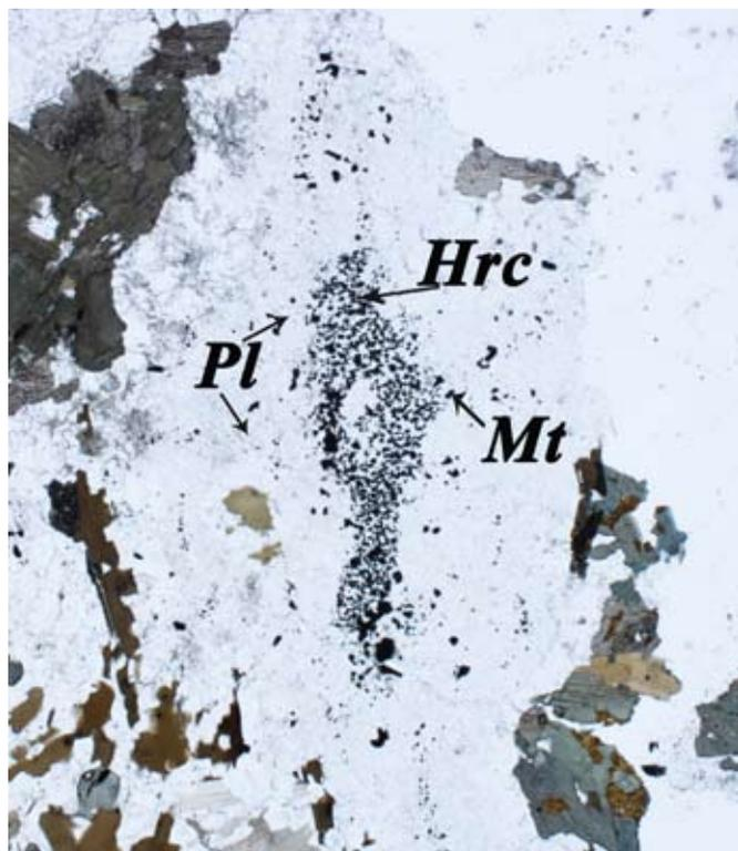
Рис. 5. Шпинель-плагіоклазовий агрегат, Малинський участок. Изображение под поляризационным микроскопом. Условные обозначения соответствуют приведенным на рисунке 2
