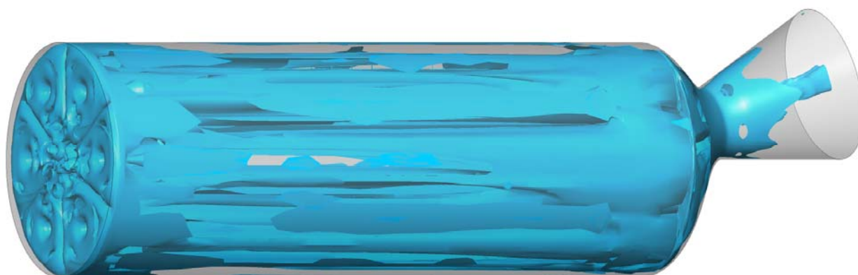
Рис. 5. Визуализация турбулентных пространственных структур в проточной части РДТТ (инвариант Q)
