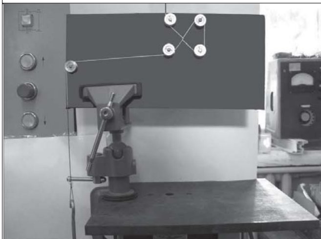
Рис. 2. Общий вид приспособления для испытаний нитей на перетирание.
