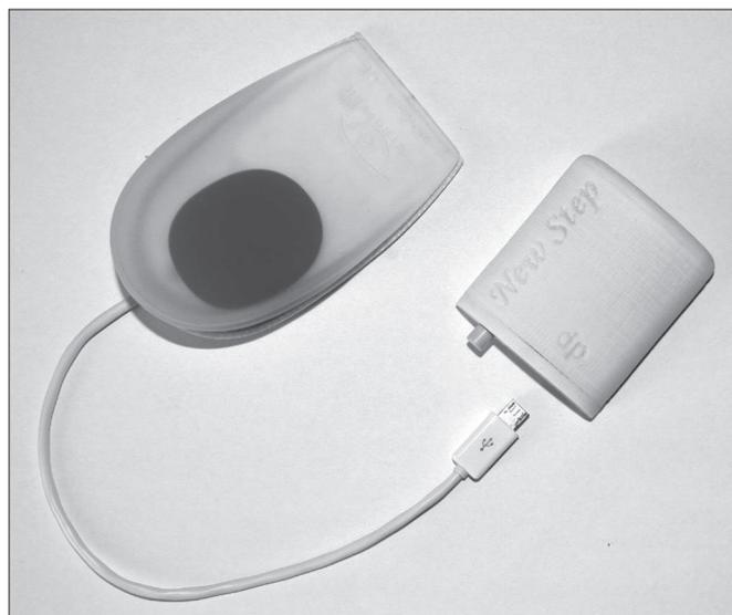
Рис. 1. Анализатор нагрузки "RehabiliStep"
