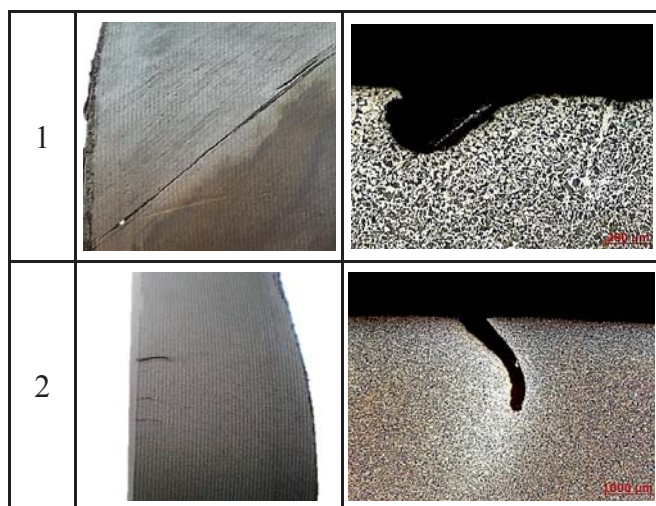
Рис. 1. Поверхность и микроструктура участка с дефектом отбракованных полуобработанных осей
