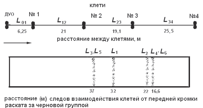
Рис. 4. Расстояние между черновыми клетями стана 1680 и положение следов взаимодействия клетей на раскате
