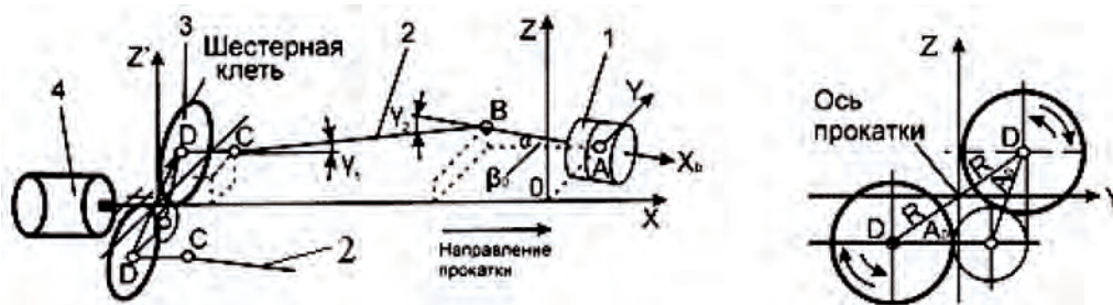
Рис. 5. Расчетная схема главного привода прошивного стана ТПА с возможными отклонениями элементов привода и рабочего валка от проектных положений
