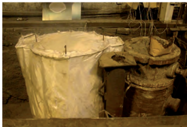
Рис. 3. Общий вид литейных форм валков контрольного и опытного с теплоизоляцией
