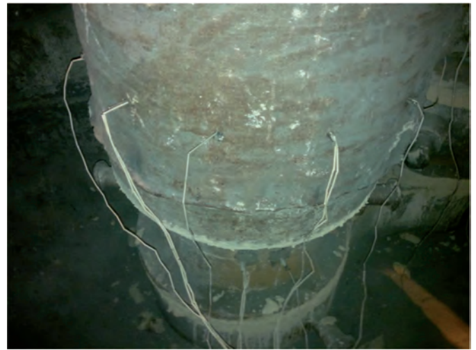
Рис. 1. Общий вид термопар, установленных в кокиле опытного валка
