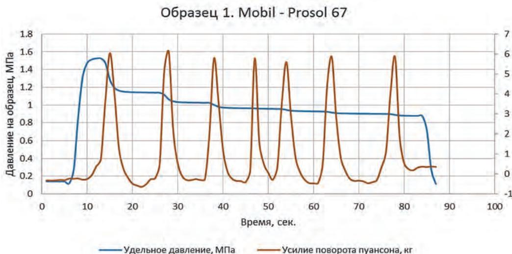
**Рис. 4. График изменения удельного давления на поверхность образца и усилия во время поворота пуансона (Образец № 1. Смазка Mobil Prosol 67)**
