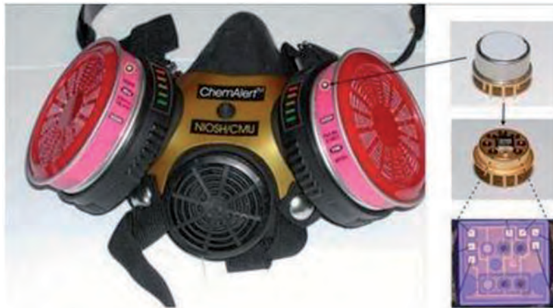
Рис. 4. Перспективний респіратор з датчиками, заглибленими в сорбент, що сигналізують про наближення закінчення терміну служби фільтра (NIOSH)
