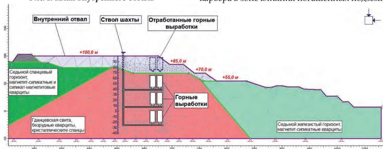
Рис. 2. Профиль внутреннего отвала по разрезу I-I
