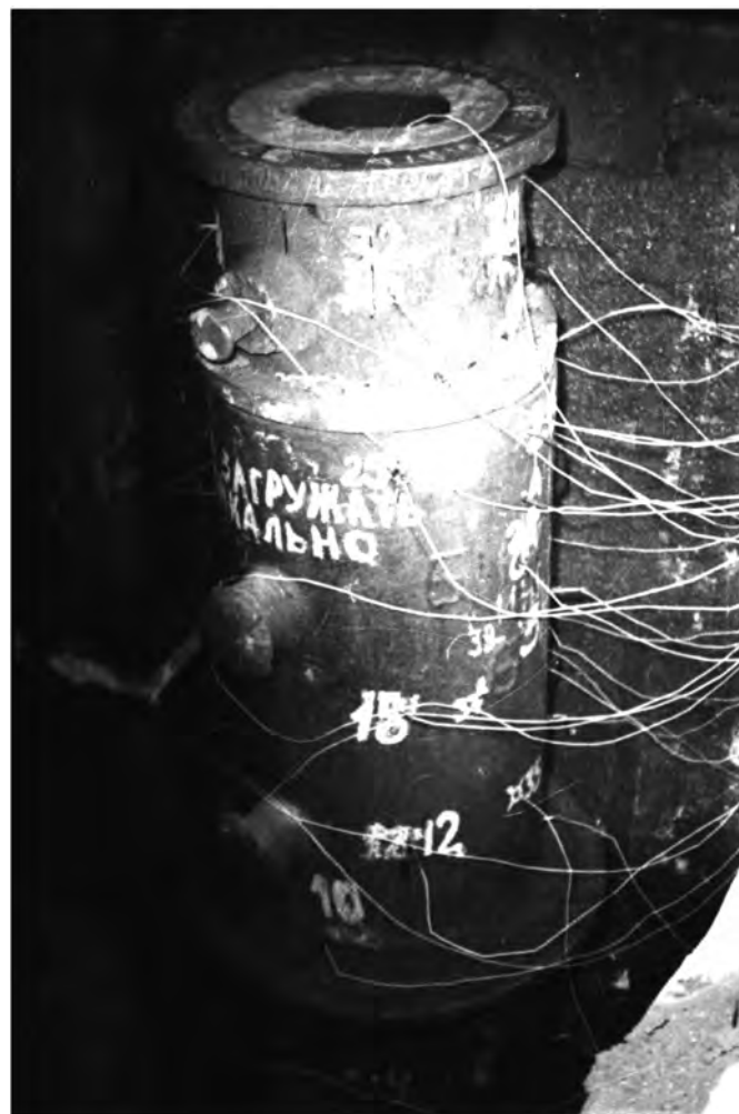
Рис. 1. Комбинированная кокильная и песчаная форма с хромель-алюмелевыми термопарами перед заливкой валка массой 2200 кг
