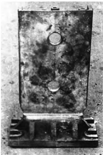
Рис. 1. Поддон с двумя литниковыми отверстиями
