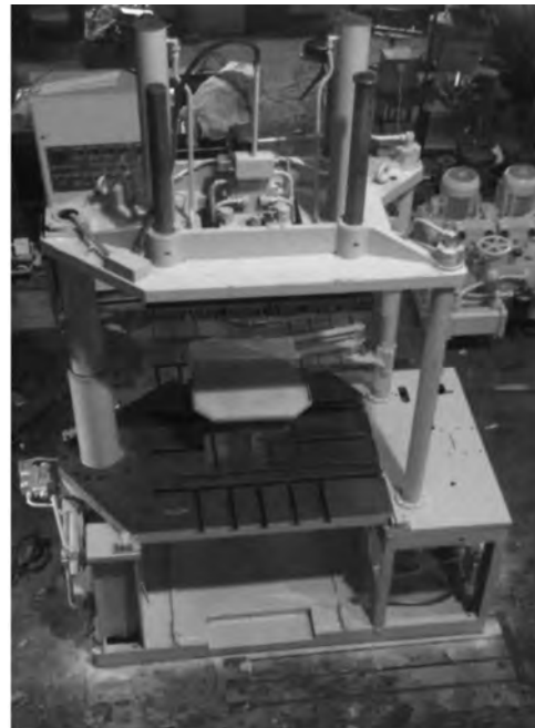
Рис. 3. Установка под низким давлением мод. У95А
