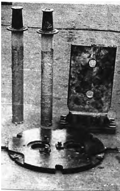
Рис. 2. Оснастка для заполнения двухместной формы «корпус фильтра» из двух металлопроводов
