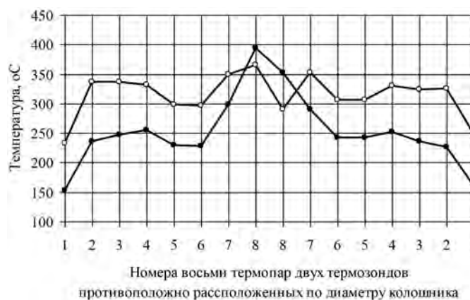
Рис. 2. Диаграммы изменения температур термозондами на колошнике доменной печи № 6: – о – базовый период (Б); – ● – опытнй период (О); табл. 2
