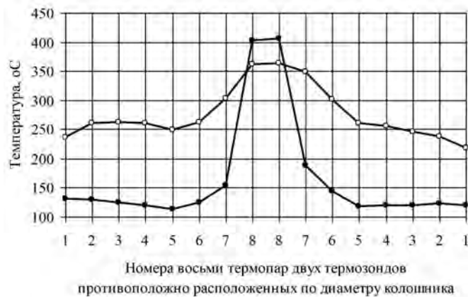
Рис. 1. Диаграммы изменения температур термозондами на колошнике доменной печи № 8: – о – базовый период (Б); – ● – опытнй период (О); табл. 1
