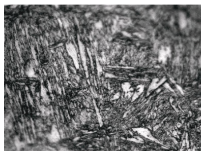
Рис. 6. Мікроструктура сталі 4X5MФ1С після загартування від 1100 °С (мартенсит крупно-голчастий, аустеніт остатній і карбіди), *500
