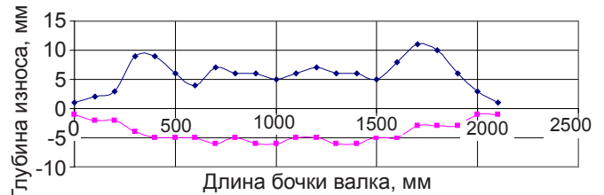
Рис. 4. Профиль выработки парных горизонтальных валков обжимной клетки (серийный и наплавленный композицией: лента 08кп и флюс И-КФ-60 . Прокат – 526 тыс. т.)
