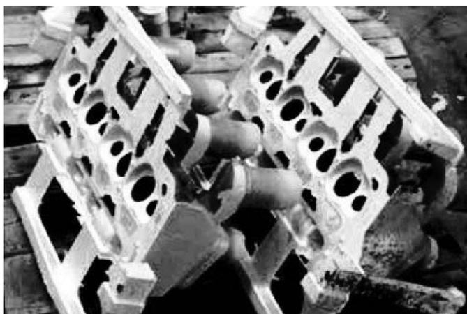
Рис. 3. Головки цилиндров отлиты в песчаную форму с использованием сплава системы Al-Ce-Mg [7]
