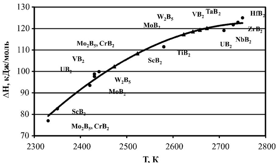
Залежність теплоти плавлення боридів від температури плавлення їх евтектик у сплавах LaB<sub>6</sub> – MeB. ● – теплоти плавлення боридів при температурі евтектик, ▲ – теплоти плавлення боридів у вільному стані CrB<sub>2</sub>, Mo<sub>2</sub>B<sub>5</sub>, ScB<sub>2</sub>, MoB<sub>2</sub>, W<sub>2</sub>B<sub>5</sub>, UB<sub>2</sub> і VB<sub>2</sub>, що отримані методом інтерполяції.
