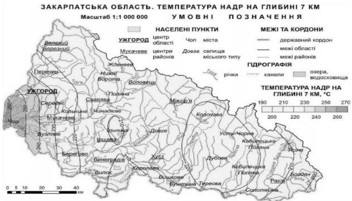
Рис.2. Розподіл температури земних надр на глибині 7 км
