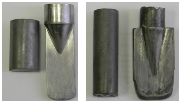
Рис. 5 – Исходные и сдеформированные заготовки:
