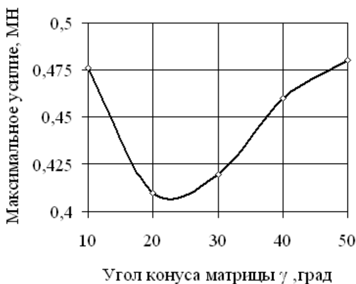
Рис. 6 – Влияние угла конуса матрицы на усилие выдавливания с раздачей
