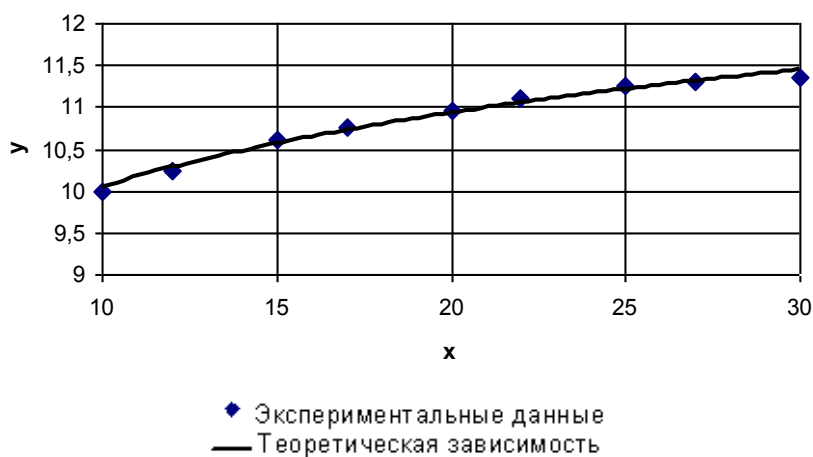
Рис. 1 – Зависимость микротвердости ( y ) от плотности тока ( x ) для сплава АМг6
