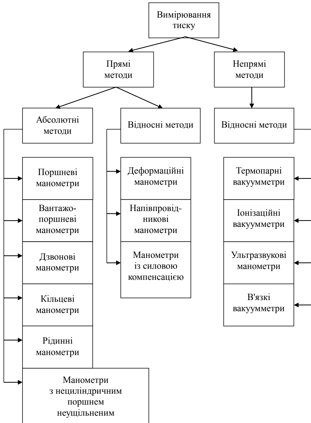
Рис. 2 – Методи вимірювання тиску (напору)
