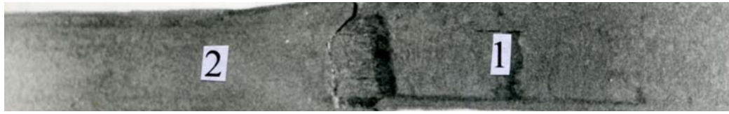
Рисунок 1 – Две полосы, сваренные встык в процессе совместной прокатки в валках (вид сверху):
