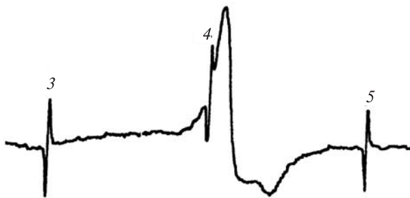
Рис. 4. Вид спектра ЭПР ионов Zr^{3+} в порошкообразных образцах синтетического ZrO_2 . Цифрами 3, 4, 5 обозначены соответствующие линии секстета эталонного образца MgO : Mn^{2+} .
