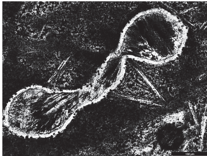
Рис. 5. Перехідний інтервал від зони загартування до зони мандельштейну.
