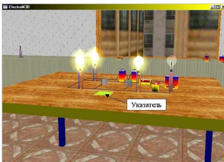
Рис. 2. Дослідження роботи послідовно з'єднаних джерел електричної енергії та споживачів
