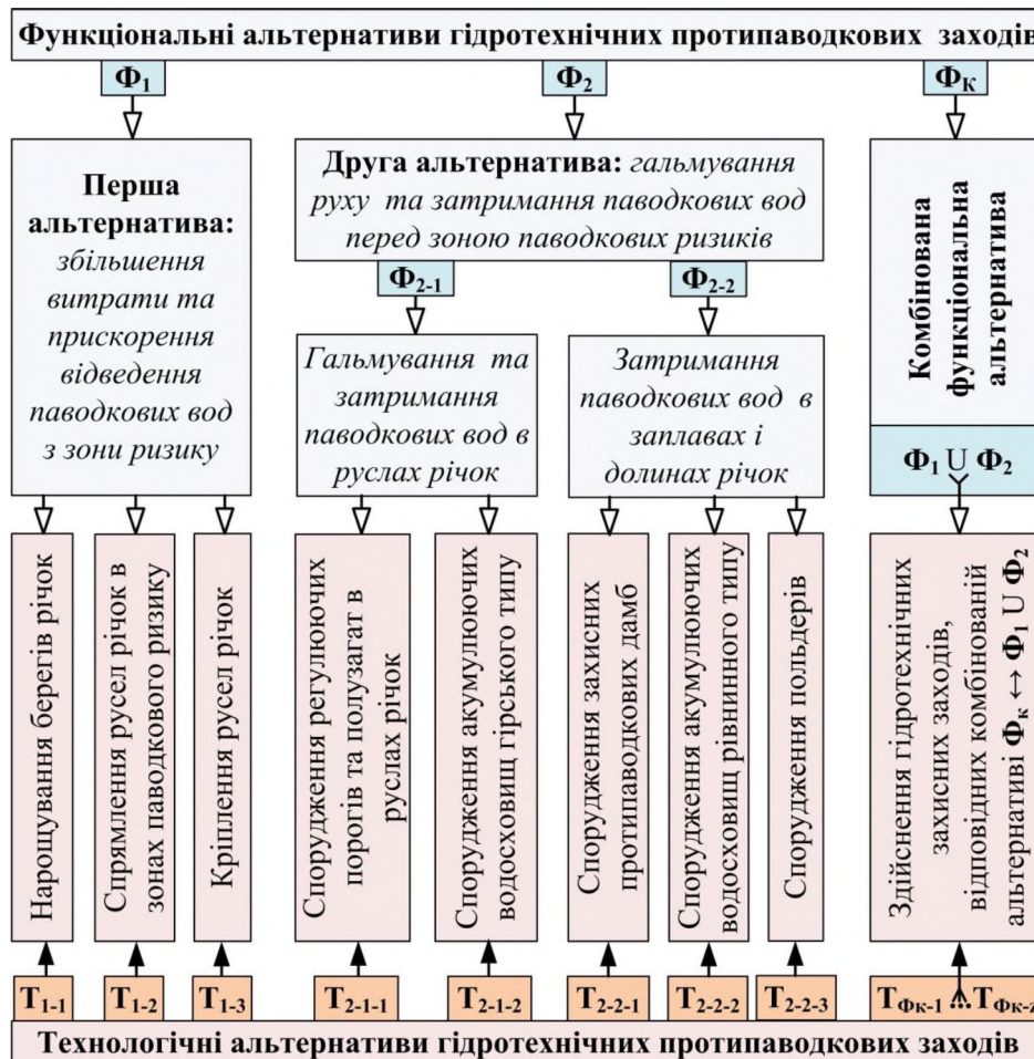
Рис. 1. Системна схема гідротехнічних проти-паводкових заходів
