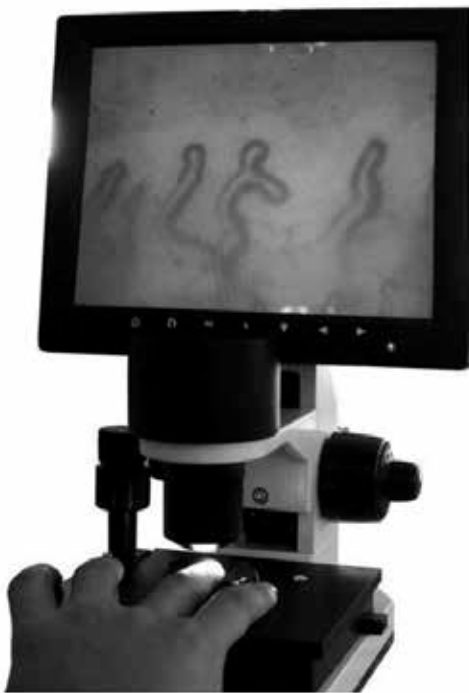
Рис. 1. Зовнішній вигляд апаратної частини капіляроскопа на базі JoyMed JM-1004, який використовувався для отримання відеоданих [7, 8]
