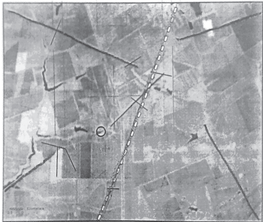
Рис. 3. Збільшений фрагмент схеми результатів регіонального структурного дешифрування радіолокаційних даних ДЗЗ на фоні синтезованого сканерного багатозонального К3 LANDSAT ETM+ із супутника “LANDSAT-7” від 01.06.2002 р. (сьомий, четвертий і другий канали, псевдокольори; акад. НАНУ В. І. Лялько, д-р геол. наук О. Т. Азімов)
