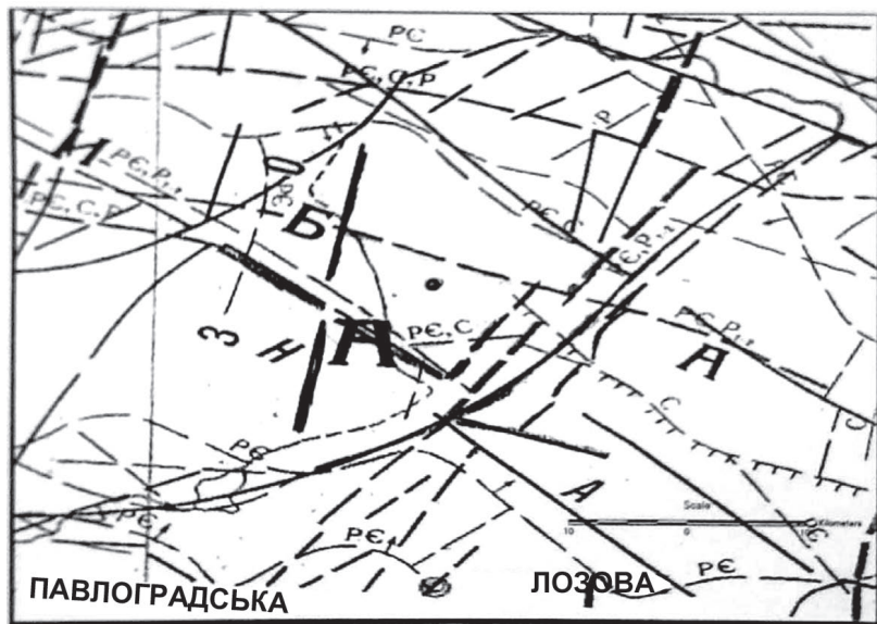
Рис. 2. Фрагмент “Карта розривних порушень та основних лінеаментів у зоні дослідної свердловини на сланцевий газ (Юзівська площа, Харківська обл.)” М 1:1 000 000 [М. А. Крилов та ін., 1988]
