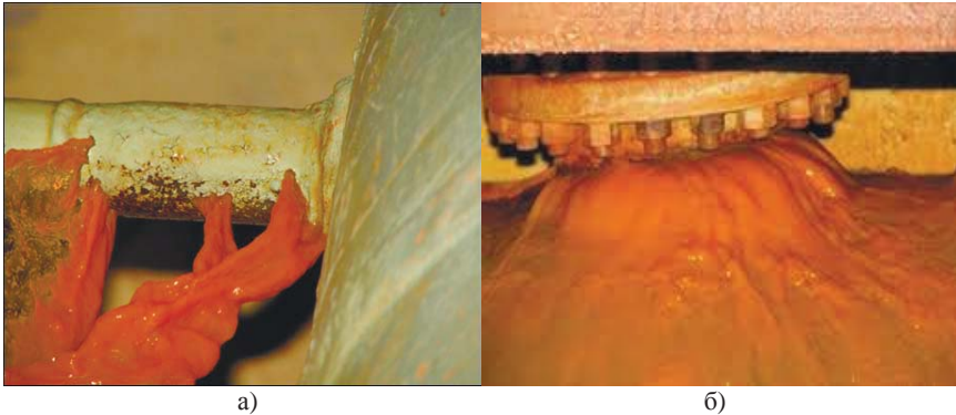
Рис. 1. Фотоматеріали інциденту з розливом радіоактивного дезактиваційного розчину на Ігналінській АЕС, Литва, жовтень 2010: вид на трубопровід, що зазнав розриву (а), загальний вид на частину розливу (б) [20]
