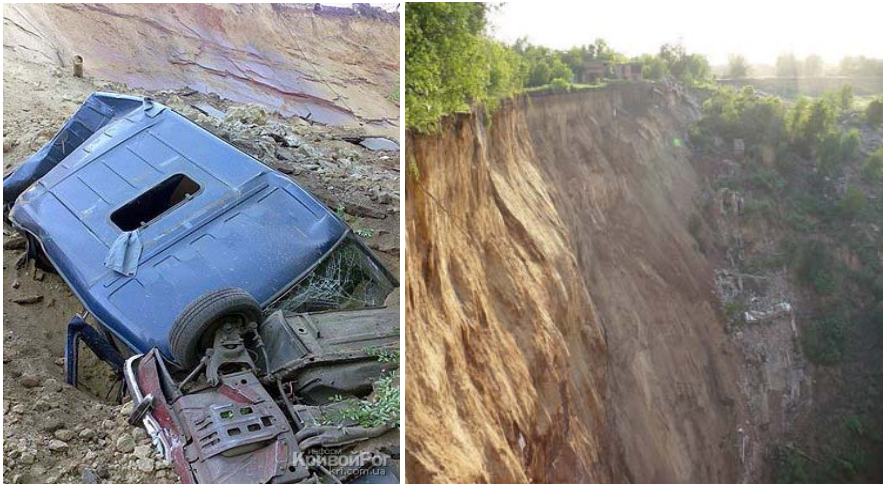
Рис. 1. Провал у області видобутку руди, що стався від підземного вибуху з масою вибухівки понад 50 тон, що стався поблизу м. Кривий Ріг (а); провал кінцевої частини міста Кривий Ріг, де частина будинків потрапила у зону провалу (б)
