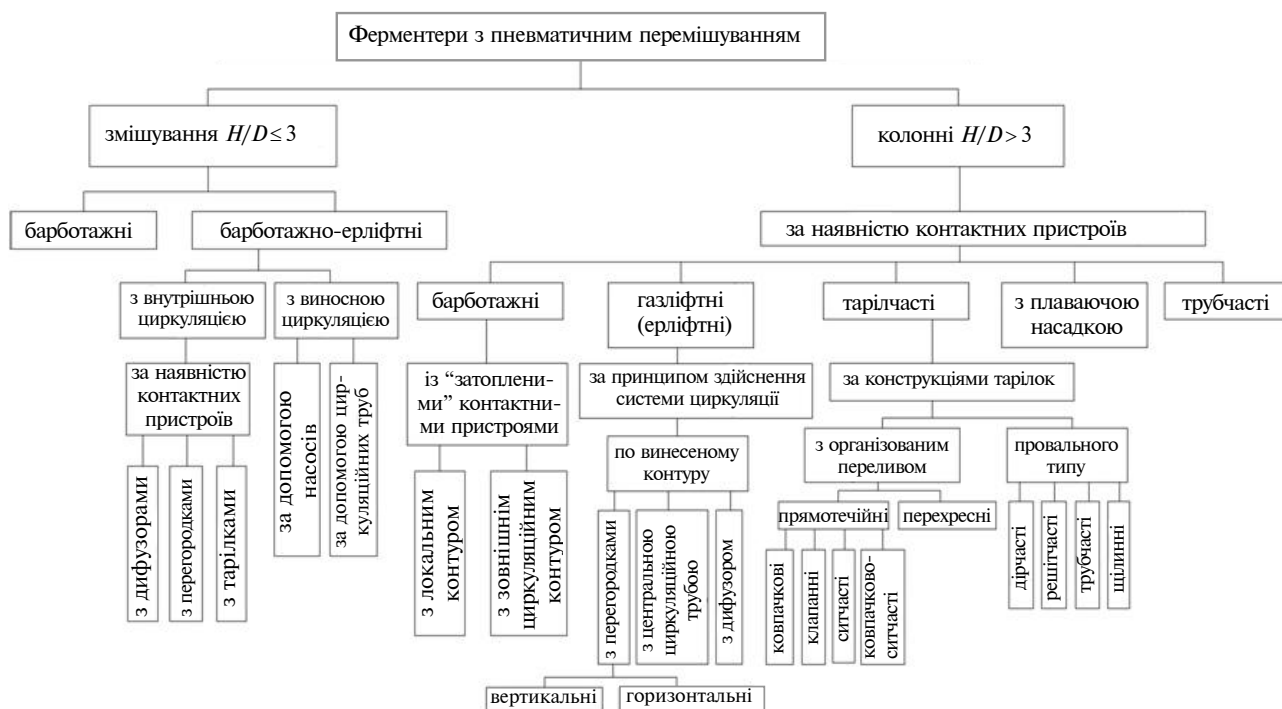
Рис. 6. Схема класифікації ферментерів з пневматичним перемішуванням
