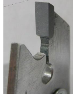
Рис. 3. Зуб дискової пили з пластинкою твердого сплаву
