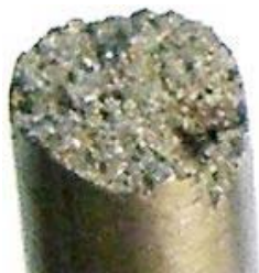
Рис. 8. Фрактография излома образца после испытания на растяжение
